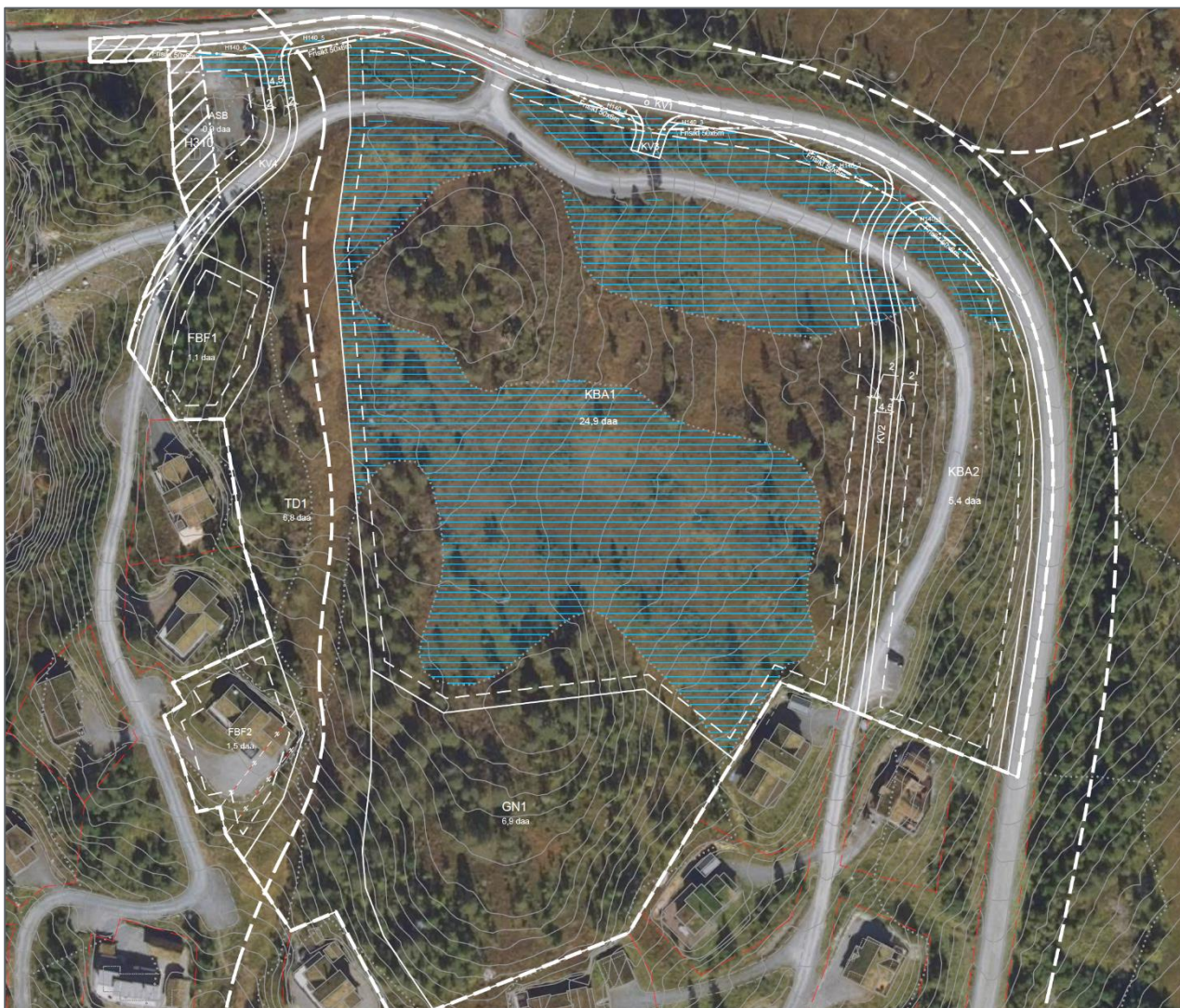
Figur 5-3: Kart som viser registrerte myrområder i AR5 (blå skravur) som berøres av regulerte utbyggingsområder. Myrrealene langs eksisterende veger er allerede drenert av veggøfter.
